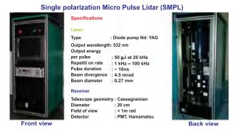
Fig. 6.12 : Micro pulse lidar
