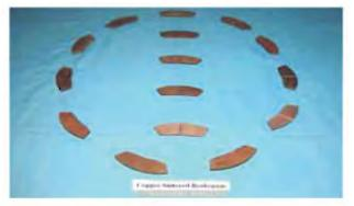
Fig. 3.2 : Copper sintered brakepads
