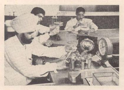
Fig. 17. Centrifuge for Shake-Down Test.
