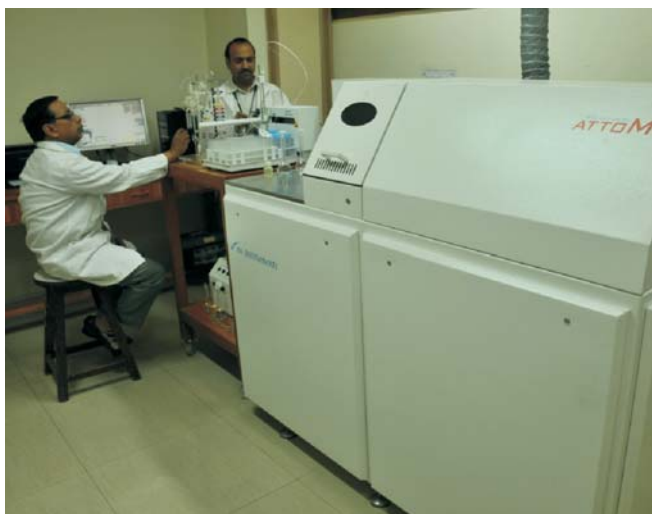
चित्र 1 : एनालिटिकल रसायन विभाग, एन पी एल में आई सी पी एच आर एम एस संयंत्र की सुविधा।
