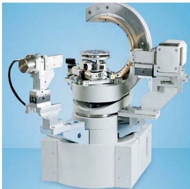
चित्र 1 : बहुउद्देशीय अर्ध ओपेन सर्कल वाला Elurian Cradle PANalytical X'Pert PRO MRD यंत्र
